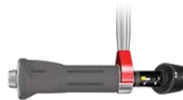
Com uma chave (5150-9-125) remova a roda do aplicador de tensão por fios.
