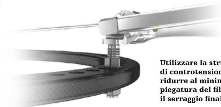
**Utilizzare la strumentazione di controtensione per ridurre al minimo la piegatura del filo durante il serraggio finale.**
