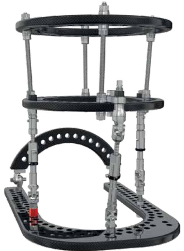
Les rondelles sphériques peuvent être utilisées aussi bien avec les anneaux en aluminium qu'en fibre de carbone. Les barres peuvent avoir un angle de 12° depuis le point neutre, avec les anneaux en aluminium. Étant donné que les anneaux en carbone sont légèrement plus épais, seule une angulation de la barre de 10° est possible.
