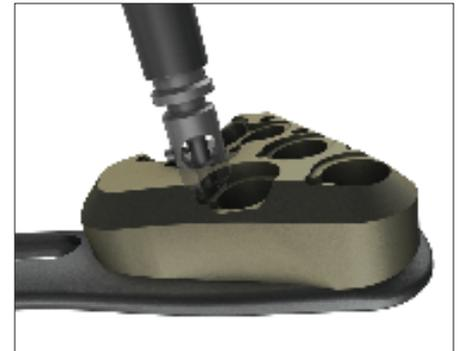
3. Der Chirurg muss das Loch auswählen, durch das der Stift in den Block eingeführt wird, um den Zielblock an der Platte anzubringen. Jedes Loch kann verwendet werden, **mit Ausnahme des distalsten radialen Styloidlochs, da dieses über keine Nut verfügt, in das die Nase des Fixierungsstifts eingeführt werden kann**. Richten Sie die Nase des Fixierungsstifts an der Nut im Zielblock aus (siehe Abbildung).
