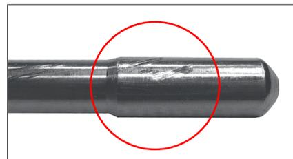
钻孔导向杆套管：表面有划痕
