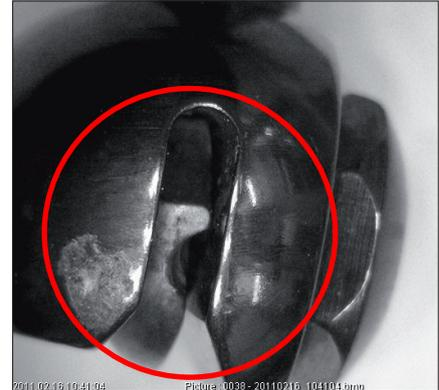
Tenzor 紧线器夹盘上的应力腐蚀
