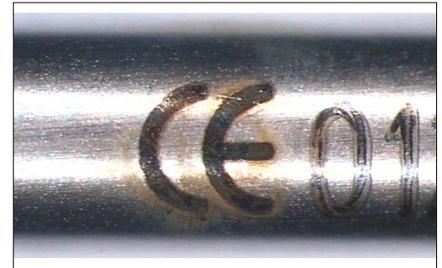
激光刻图上出现轻微腐蚀
