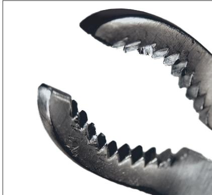
夹持钳上的齿弯曲且锁定机械装置已损坏
