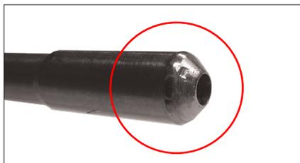
钻孔导向杆套管：套管尖端有凹痕
