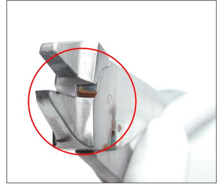
弯折夹持钳的切割设备和夹持钳的两个部件之间的缝隙的表面出现腐蚀。
