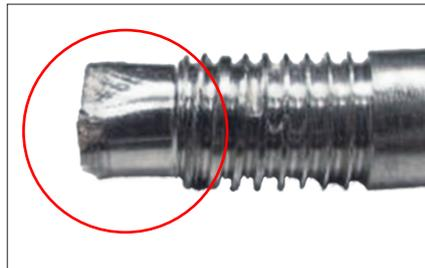
Gamma 拉力改锥的连接杆：螺纹损坏并挤压在一起
