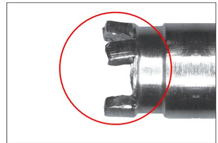
Gamma 拉力改锥：已变形/销钉已折断
